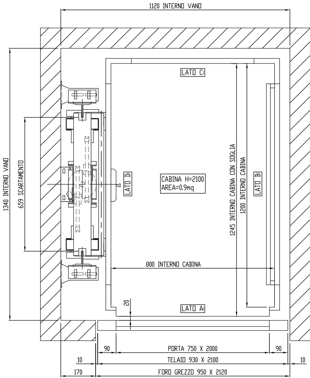
LA TOLLERANZA SULLE DIMENSIONI DEL VANO CORSA, LE CUI PARETI DOVRANNO ESSERE A PIOMBO E' DI: + - 10 mm
