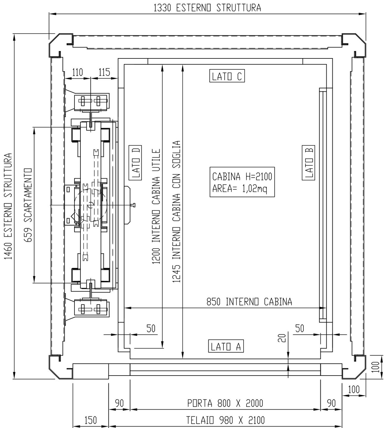
LA TOLLERANZA SULLE DIMENSIONI DEL VANO CORSA, LE CUI PARETI DOVRANNO ESSERE A PIOMBO E' DI: + - 10 mm
