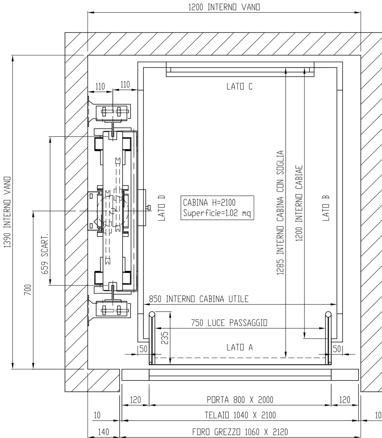
LA TOLLERANZA SULLE DIMENSIONI DEL VANO CORSA, LE CUI PARETI DOVRANNO ESSERE A PIOMBO E' DI: + - 10 mm
