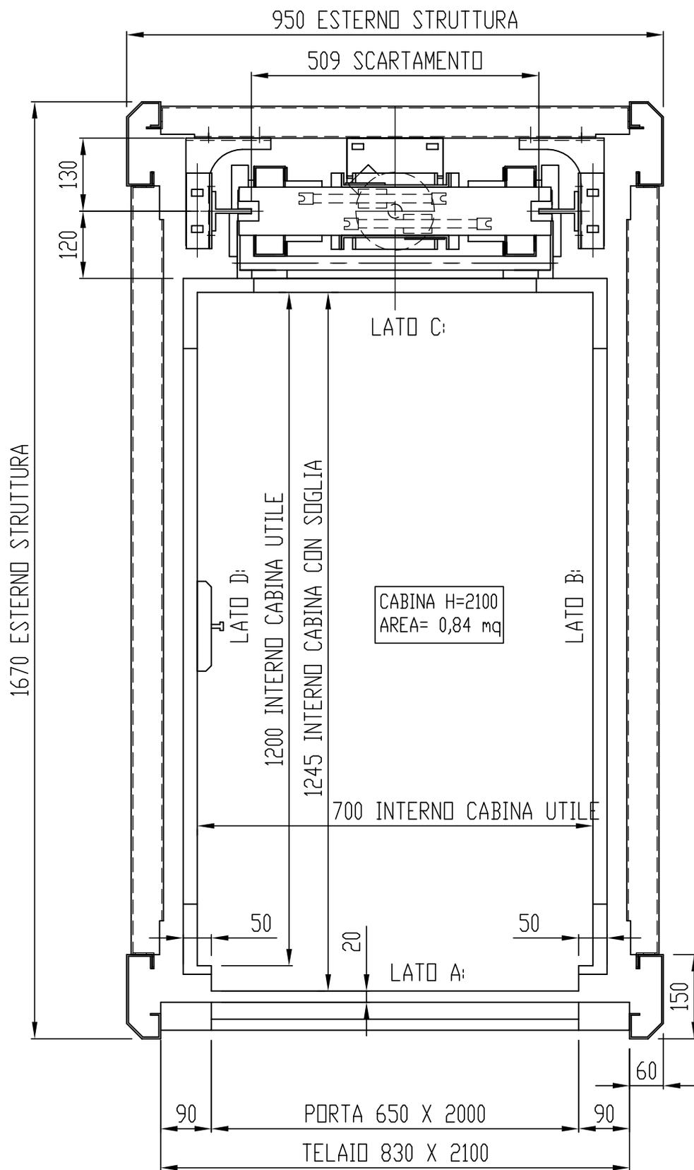
LA TOLLERANZA SULLE DIMENSIONI DEL VANO CORSA, LE CUI PARETI DOVRANNO ESSERE A PIOMBO E' DI: + - 10 mm
