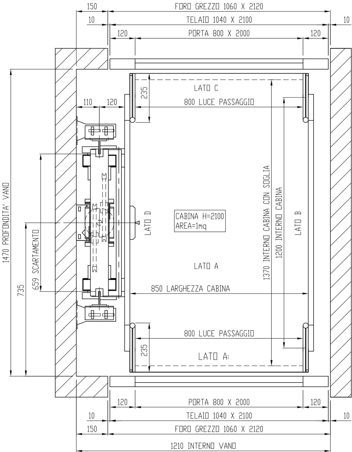
LA TOLLERANZA SULLE DIMENSIONI DEL VANO CORSA, LE CUI PARETI DOVRANNO ESSERE A PIOMBO E' DI: + - 10 mm
