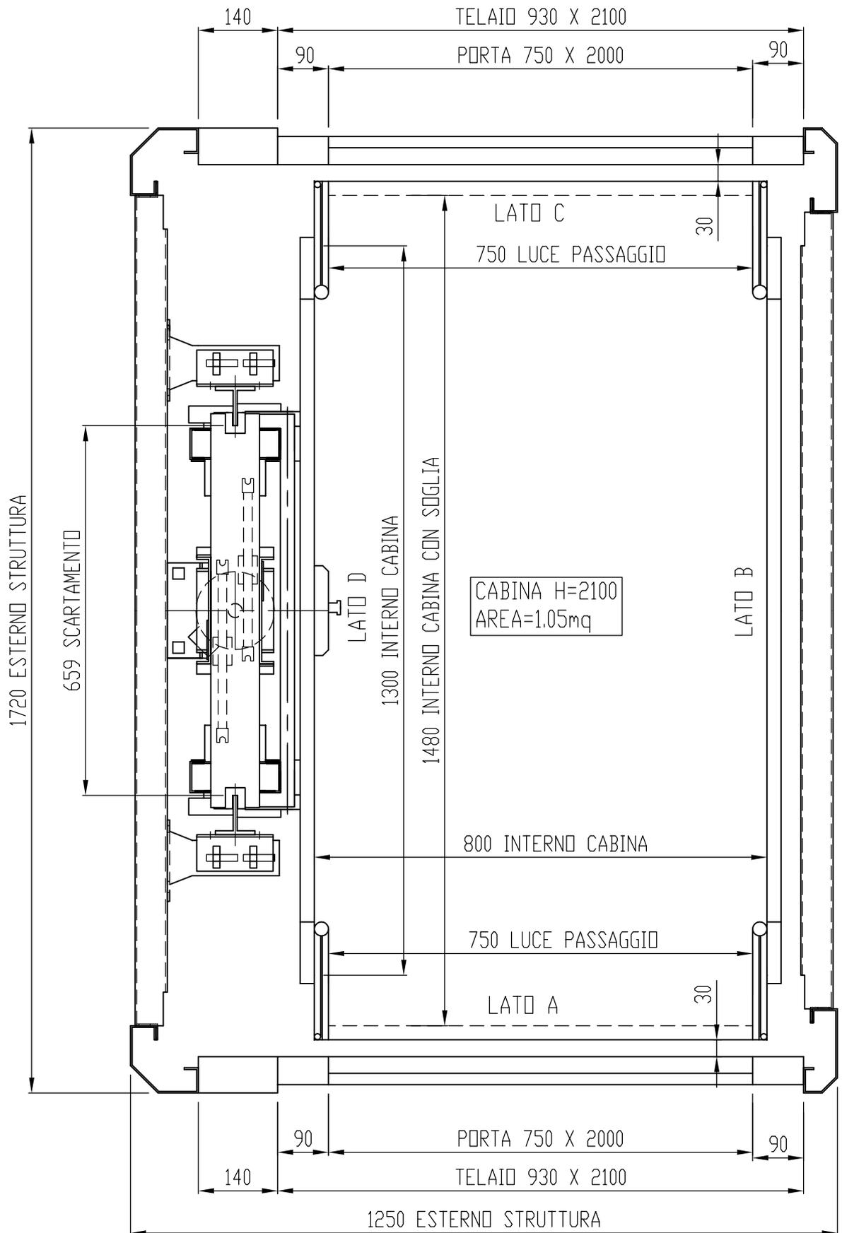
LA TOLLERANZA SULLE DIMENSIONI DEL VANO CORSA, LE CUI PARETI DOVRANNO ESSERE A PIOMBO E' DI: + - 10 mm
